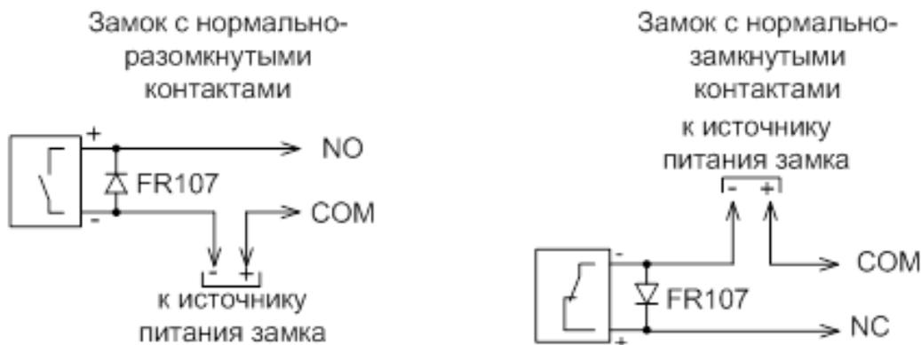
**Рисунок 5.** Рекомендуемые схемы подключения замков (разъём J10)
