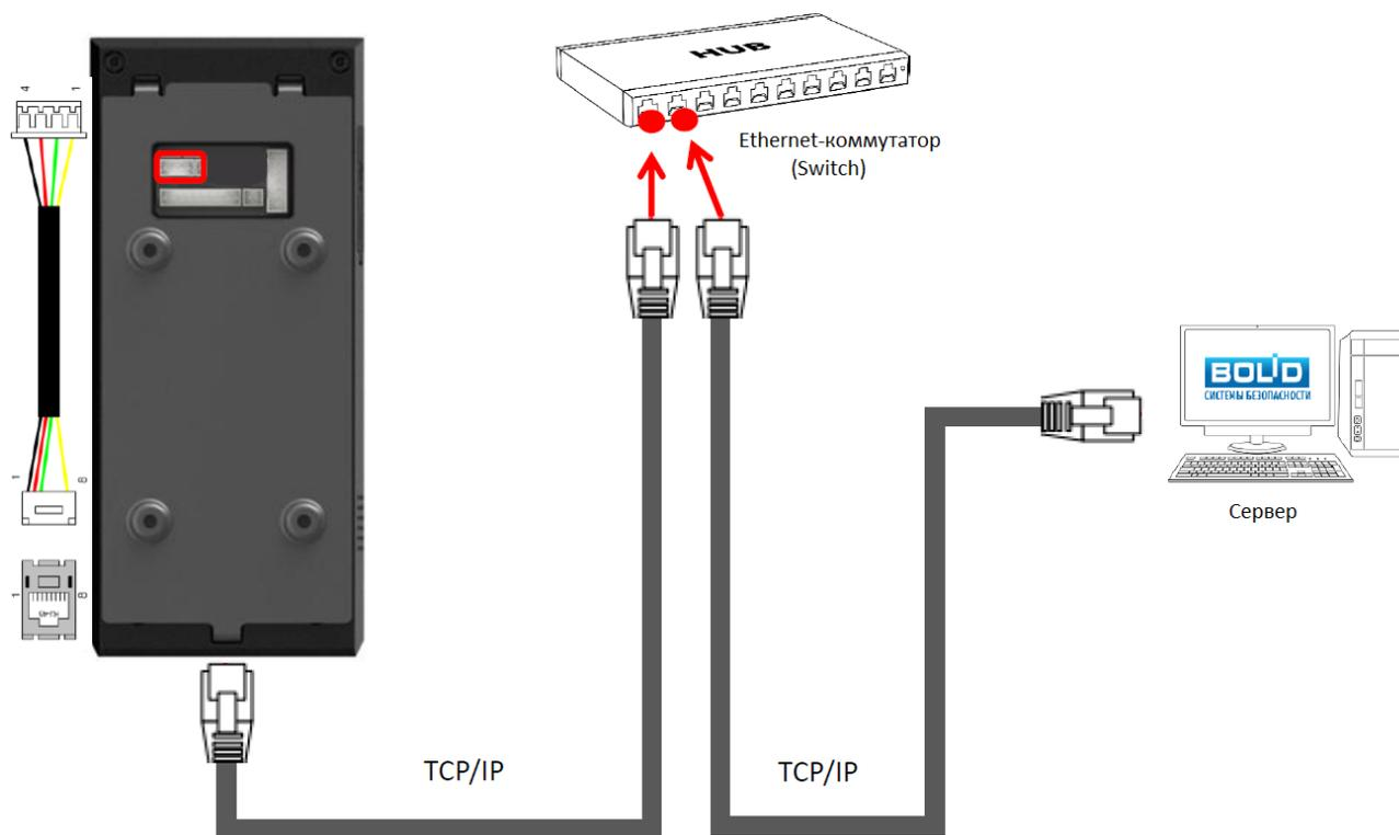
**Рисунок 6.** Подключение контроллера к ПК через Ethernet-коммутатор (Switch)
