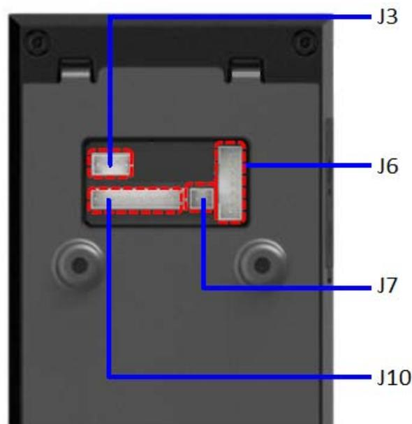
Рисунок 3. Схема расположения разъёмов
