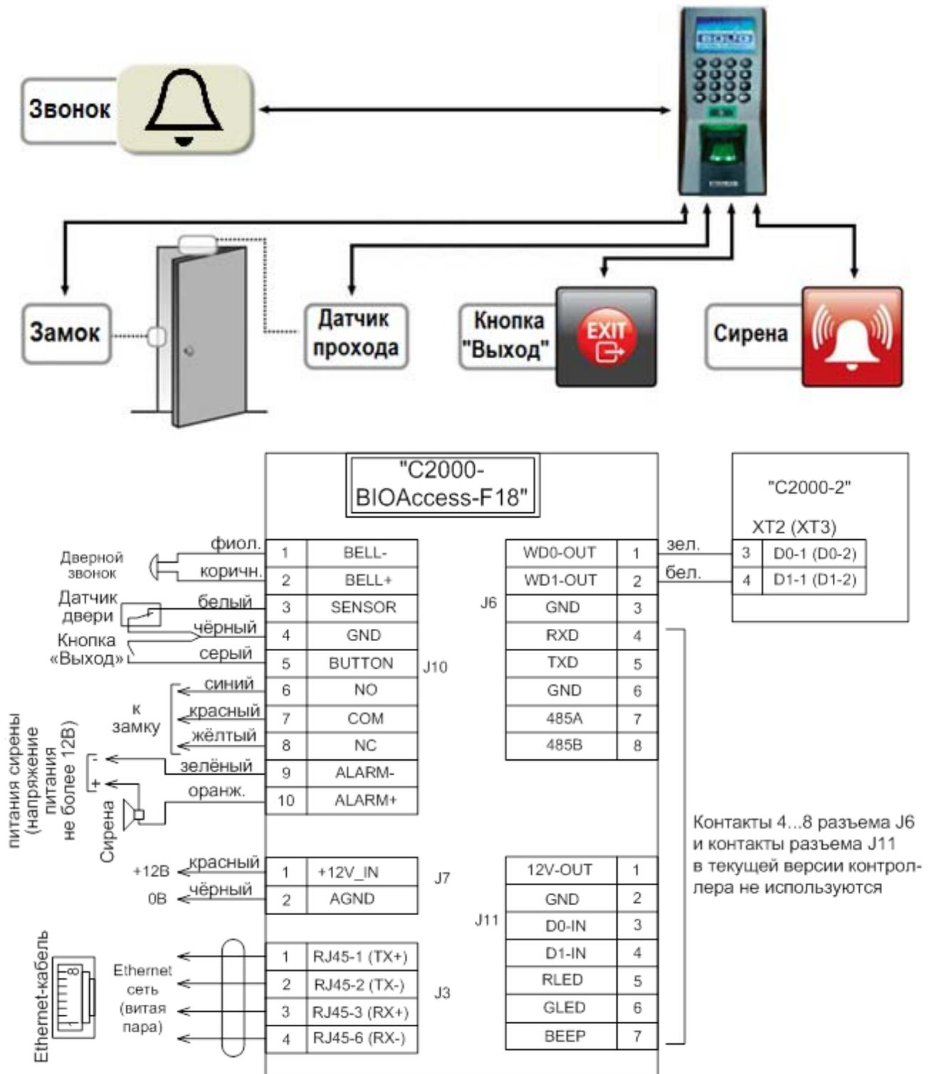
**Рисунок 4.** Схема подключений к контроллеру
