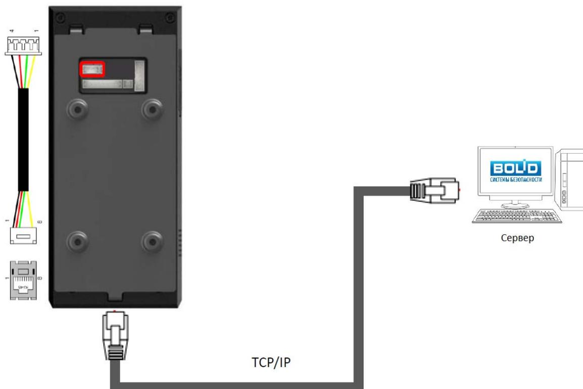
Рисунок 7. Подключение контроллера к ПК напрямую
