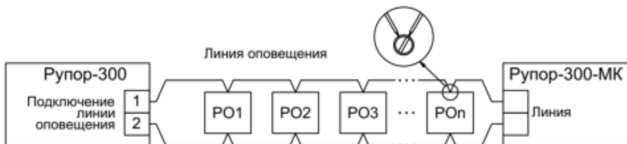
Рисунок 2. Подключение модуля Рупор-300-МК.
