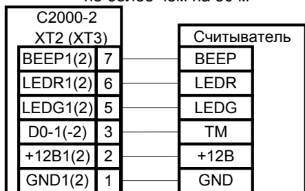
Рисунок 11. Схема подключения считывателей с интерфейсом Touch Memory
