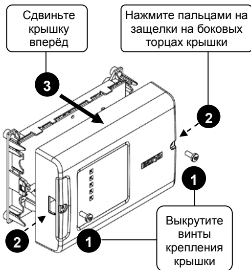
Рисунок 2. Снятие крышки контроллера
