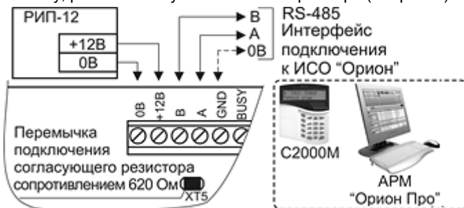
Рисунок 4. Схема подключения по интерфейсу RS-485
