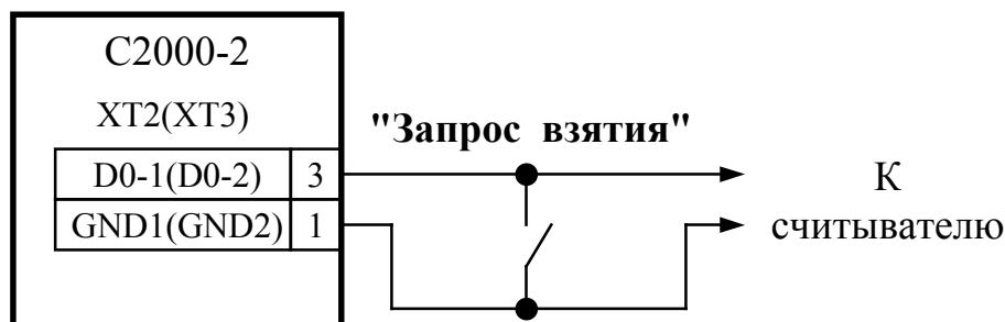
Рисунок 7 Подключение кнопки "Запрос взятия"
