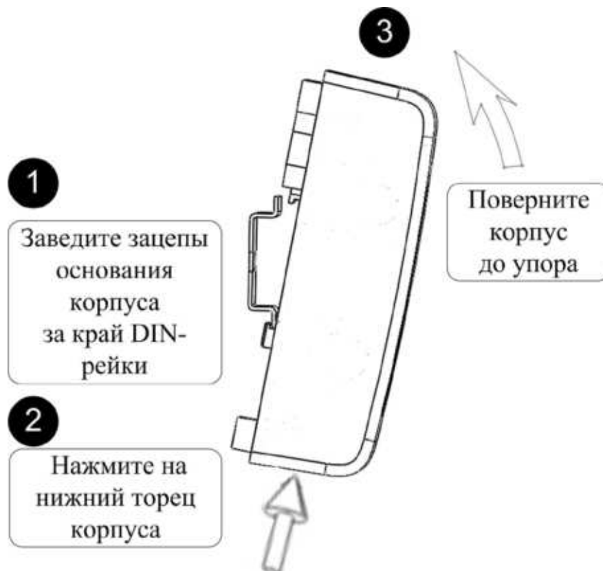
Рисунок 2.2.3 – Схема установки блока на DIN рейку.
