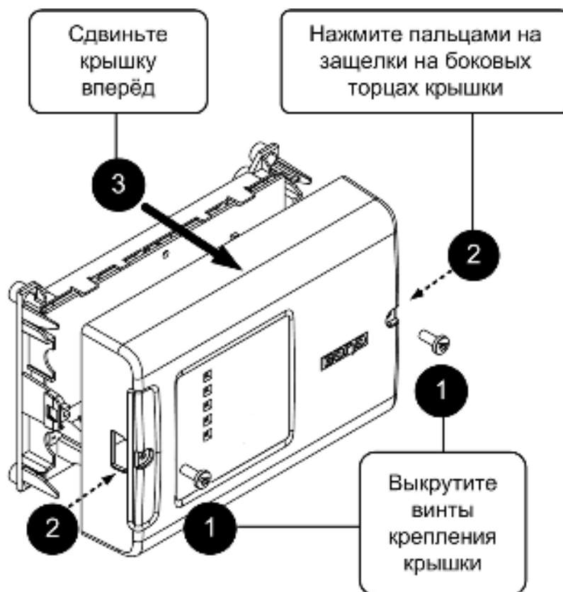
Рисунок 2.2.2 – Снятие крышки корпуса блока
