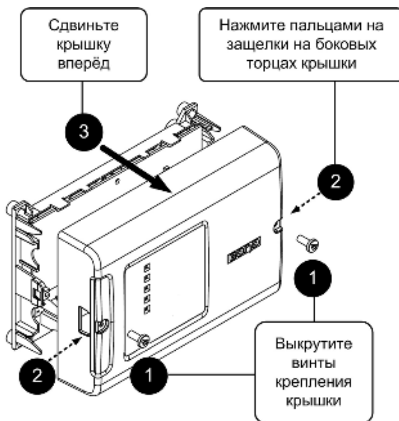
Рисунок 2.2.2 – Снятие крышки корпуса блока
