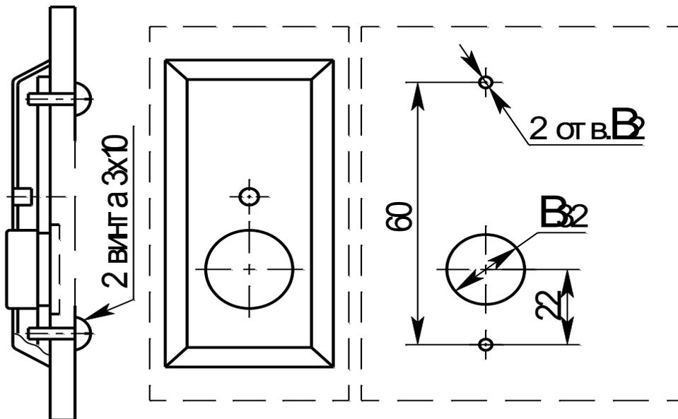
Отверстие диаметром 32мм и глубиной не менее 2мм необходимо для исключения замыкания контактов.
