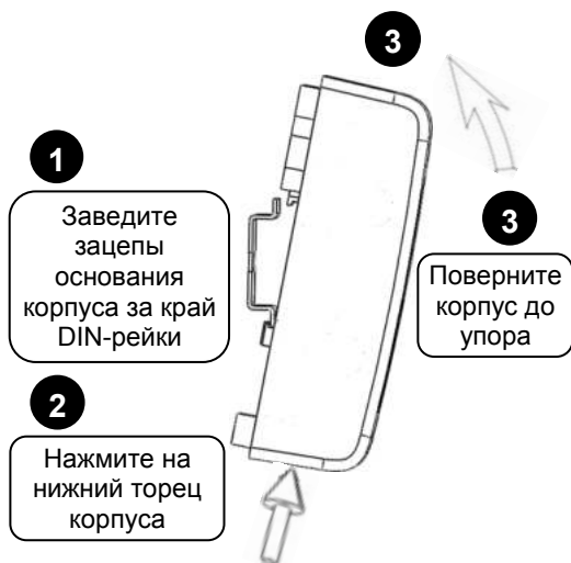
Рисунок 3. Крепление «УО-4С исп.02» на DIN-рейку
