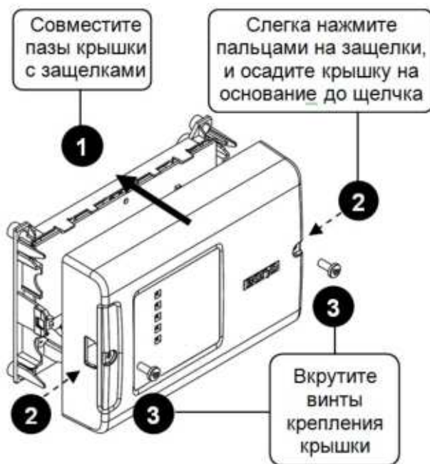
Рисунок 8. Монтаж крышки
