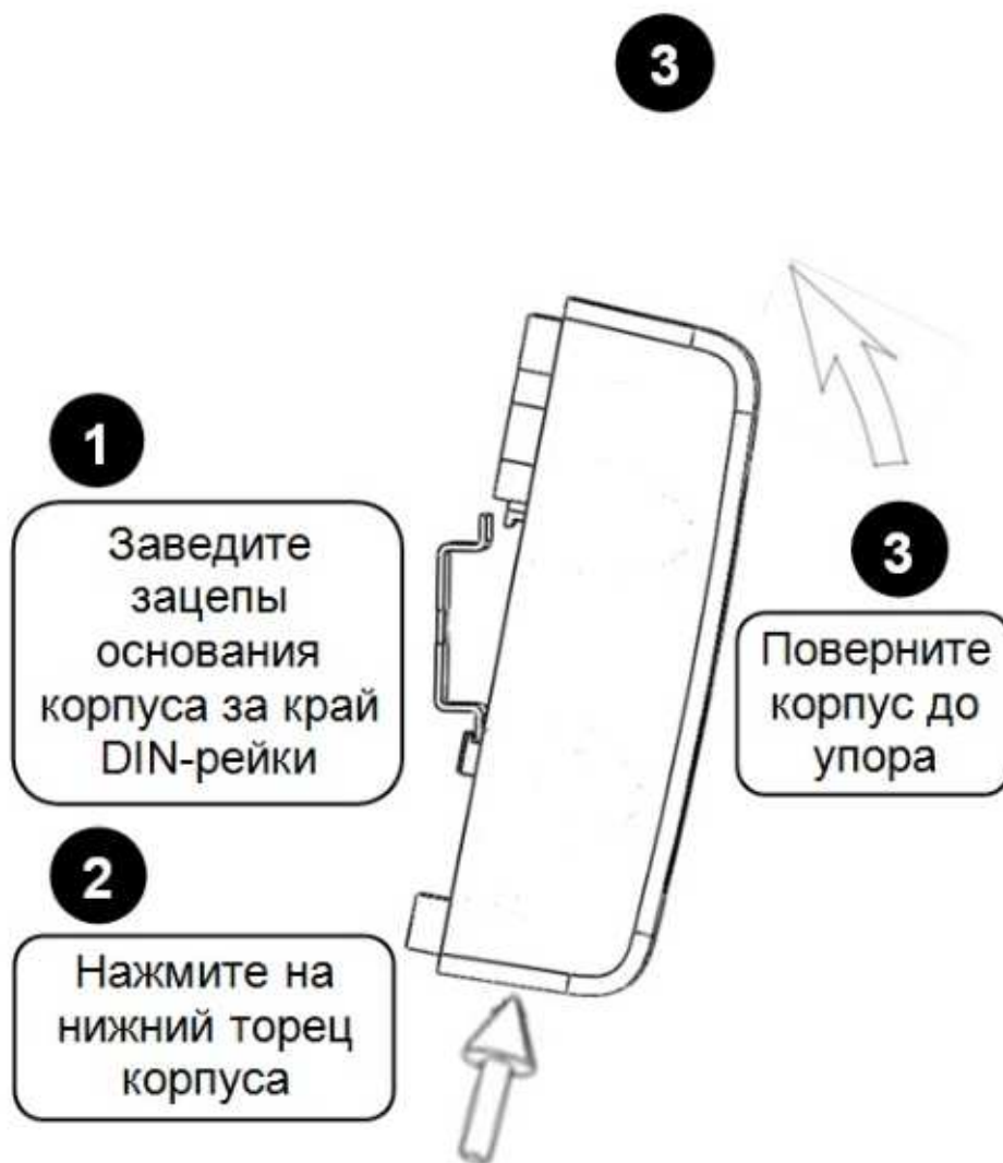
Рисунок 4. Крепление «УО-4С исп.02» на DIN-рейку
