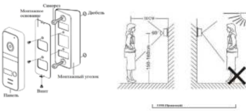
Рисунок 4. Схема установки панели
