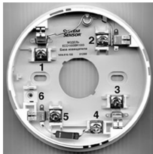
Рис. 1. Расположение контактов базы E1000R
