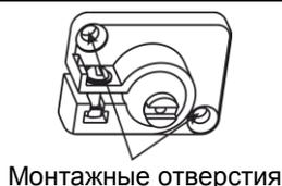
11 Совместить выступ основания извещателя с пазом шарика кронштейна и вернуть винт с внутренней стороны основания извещателя в шарик кронштейна. Установить необходимое направление извещателя и затянуть стопорный винт. При необходимости контроля антисаботажной зоны установить угол наклона в вертикальной плоскости 20°.
