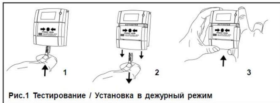
Рис.1 Тестирование / Установка в дежурный режим
