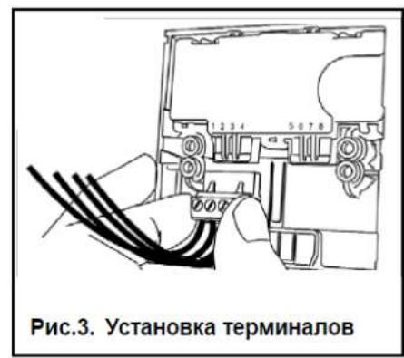
Рис.3. Установка терминалов
