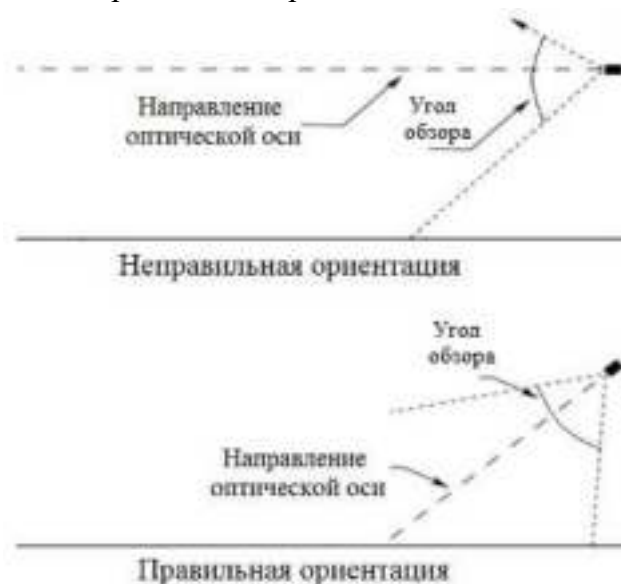
Рисунок 3 – Установка извещателя по отношению к горизонту
