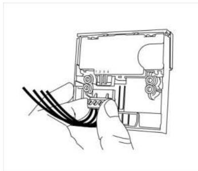
После подключения проводников к терминалу, подключите его к разъему платы извещателя. Затем извещатель крепится при помощи двух винтов к монтажной коробке, кассета задвигается до упора вверх.
