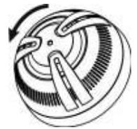
2 При использовании одного ЭП для включения извещателя установить основной ЭП (Primary).
