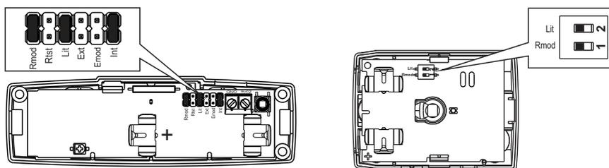
\* В дополнительных датчиках, приобретаемых отдельно от комплекта Security Hub, на вилки **Rmod** и **Lit** установите перемычки.
