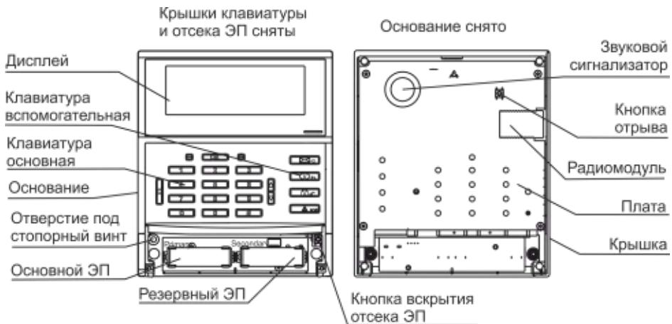
**4.1** Пульт состоит из основания, клавиатуры с закрывающейся крышкой, дисплея, платы с радиоэлементами, отсека ЭП со съемной крышкой. Снятие крышки клавиатуры возможно при снятии крышки отсека питания.
