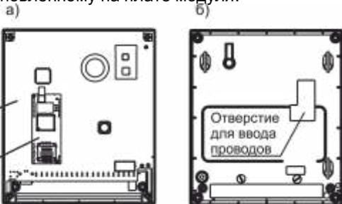
7) Установить SIM-карту(ы) в держатель SIM-карт модуля согласно рисунку (см. п. 5.3.1 действие 6), SIM-карты при этом должны быть ориентированы **контактами к плате**.
