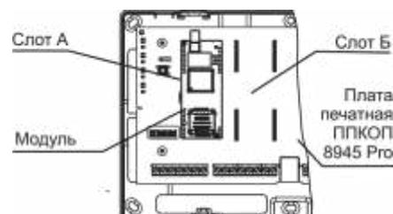
5) Подключить антенну GSM из комплекта поставки к разъему, установленному на плате модуля.
