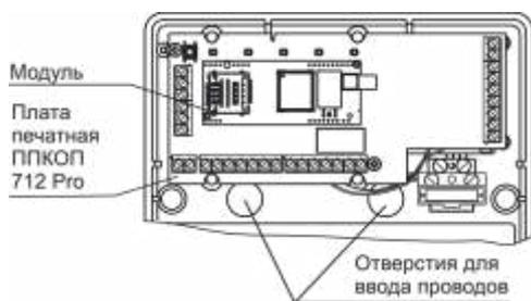
4) Подключить антенну GSM из комплекта поставки к разъему, установленному на плате модуля.
