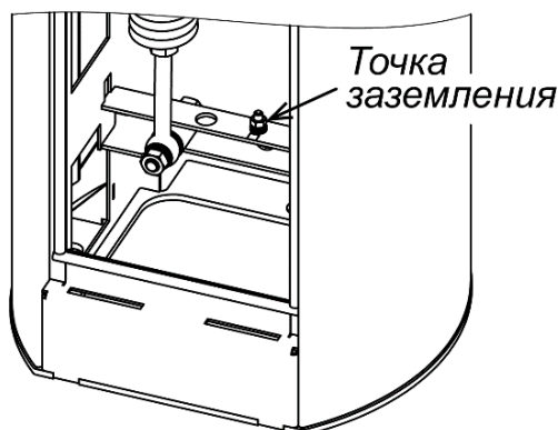
Рисунок 26. Расположение точки заземления шлагбаума
