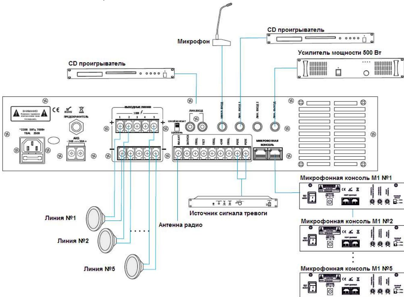
Рис. 2.1. Схема подключения
