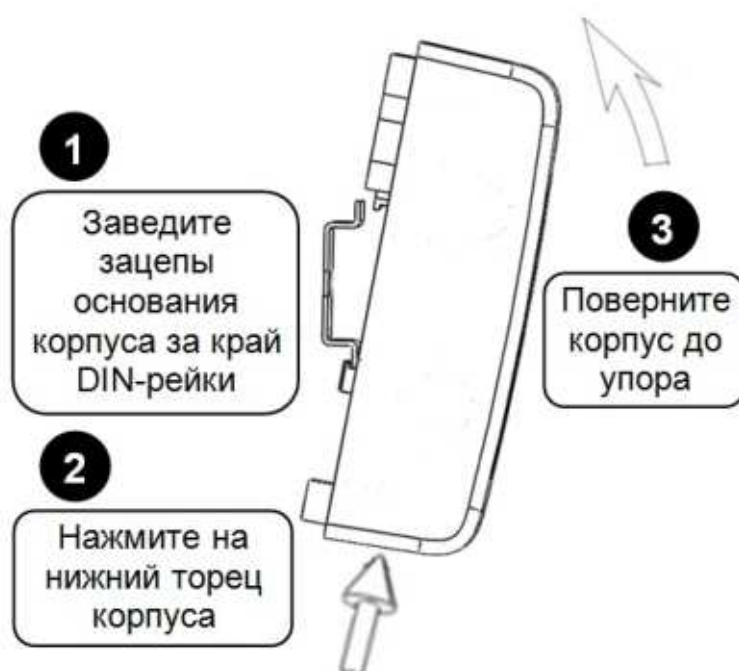
Рисунок 8.3 Крепление на DIN-рейку
