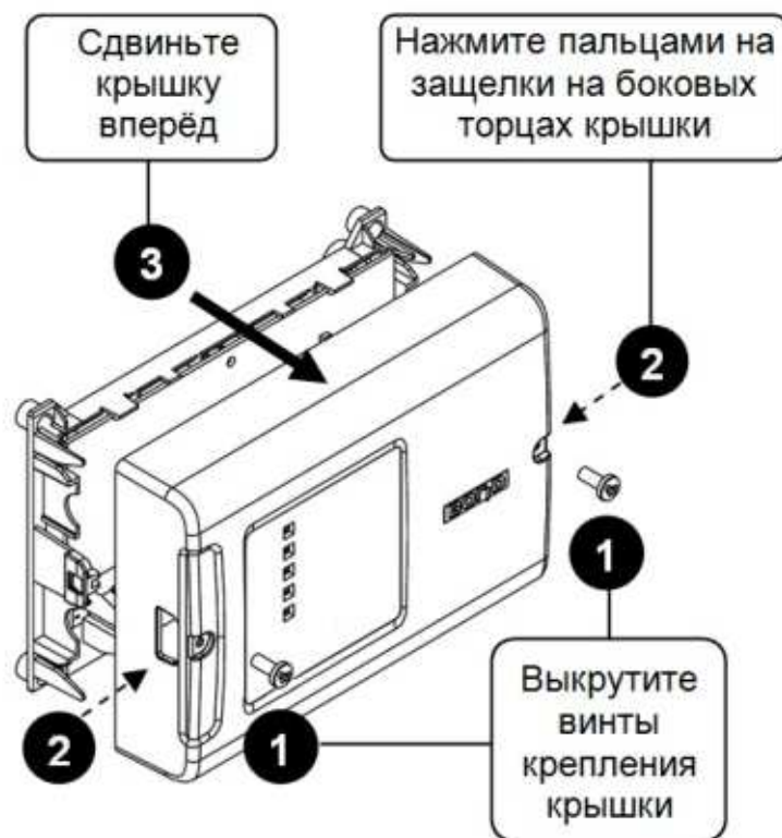
Рисунок 8.2 Снятие крышки
