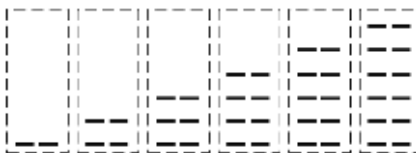
Рисунок 4 - Графическое отображение процесса заряда АКБ на ЖК-дисплее.
