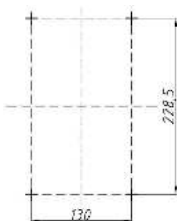
Рисунок 2.7 – Разметка для крепления блока ПРМ.
