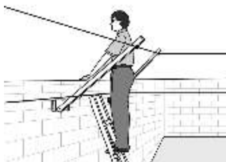
Рисунок 2.11 – Имитация преодоления зоны обнаружения при козырьковом варианте установки.
