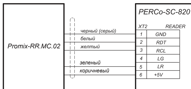
Схема подключения считывателя к контроллеру PERCo-SC-820
