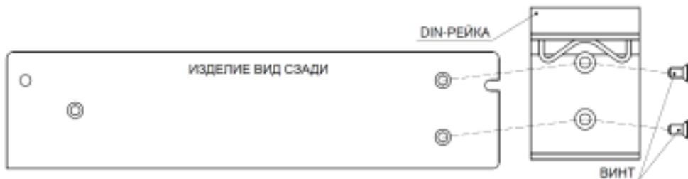
Рисунок 2 – крепление DIN-рейки.
