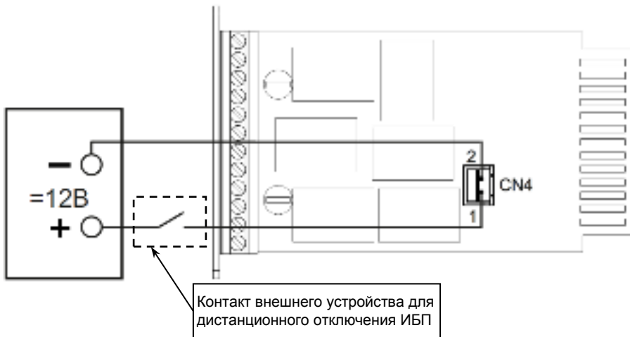
Рисунок 4 — Пример схемы подключения контакта внешнего устройства мониторинга
