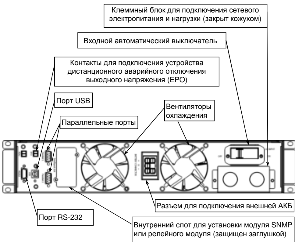
Рисунок 1 — Общий вид передней панели изделия.
