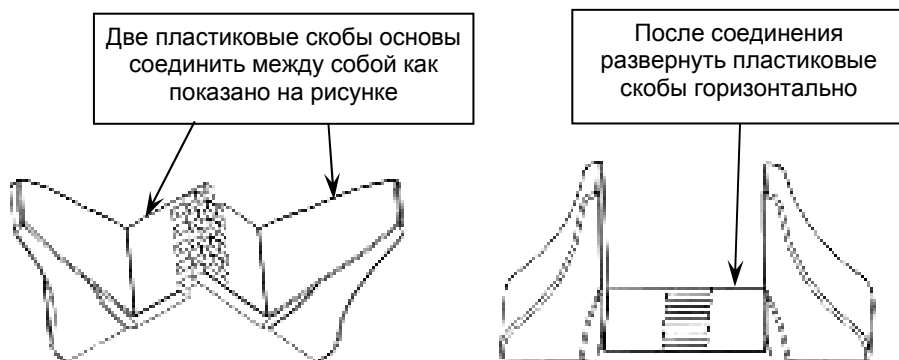
Рисунок 3 - Сборка пластиковых основ для вертикальной установки изделия.
