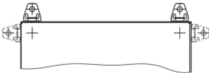
Рисунок 3 – Пример установки кронштейнов.
