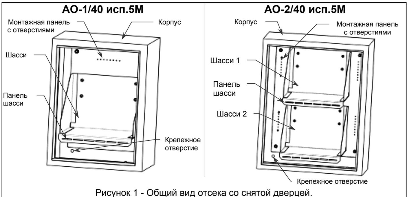
Рисунок 1 - Общий вид отсека со снятой дверцей.
