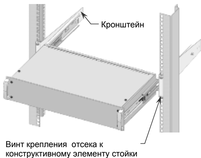
Рисунок 2 - Пример встраивания отсека в телекоммуникационную стойку
