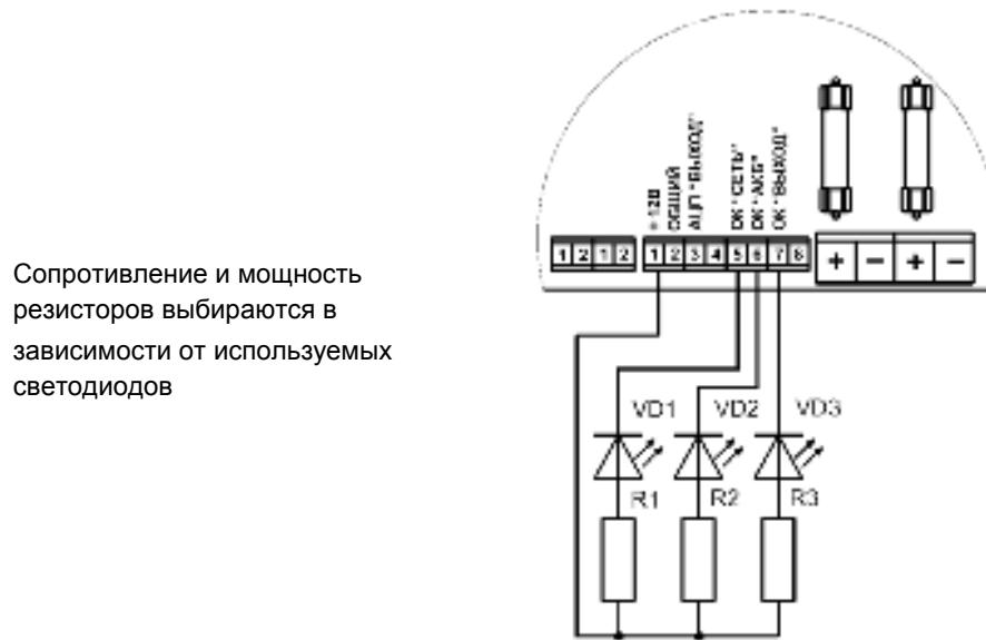
Рисунок 7. Подключение внешних индикаторов.
