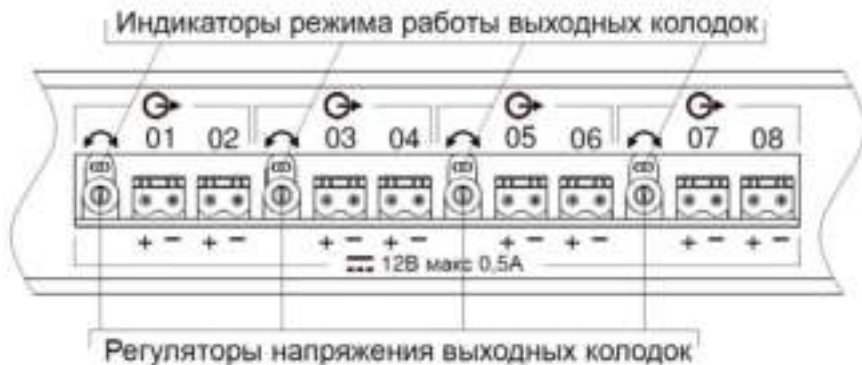
Рисунок 2 - Увеличенное изображение выходных колодок ПН.
