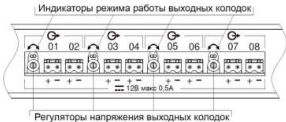
Рис. 2 Увеличенное изображение выходных колодок ПН.
