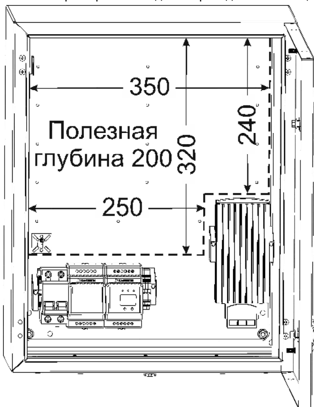
Рисунок 1 – Пространство внутри для установки доп. оборудования
