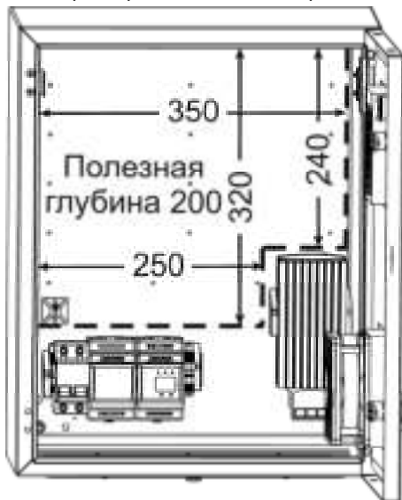
Рисунок 1 – Пространство внутри для установки доп. оборудования
