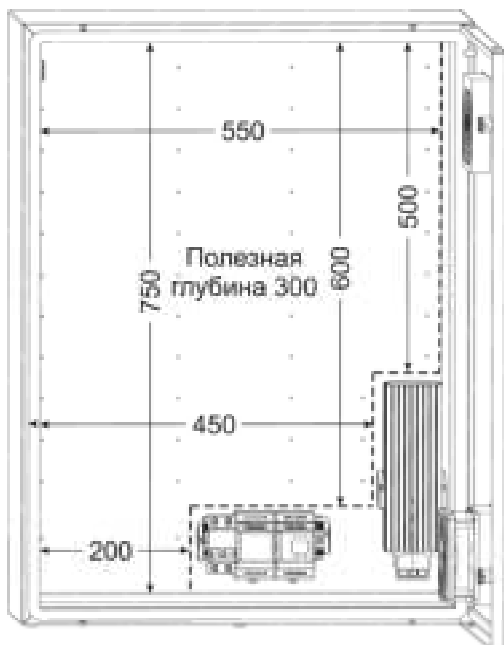
Рисунок 1 – Пространство внутри для установки доп. оборудования
