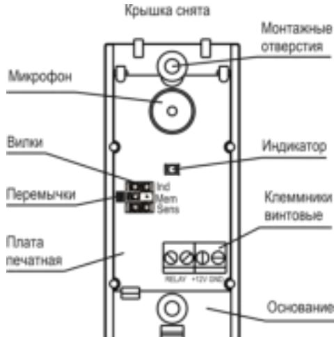
**5.1** Конструктивно извещатель выполнен в виде блока, состоящего из основания и съемной крышки. Внутри блока смонтирована печатная плата с радиоэлементами (рисунок 3).
