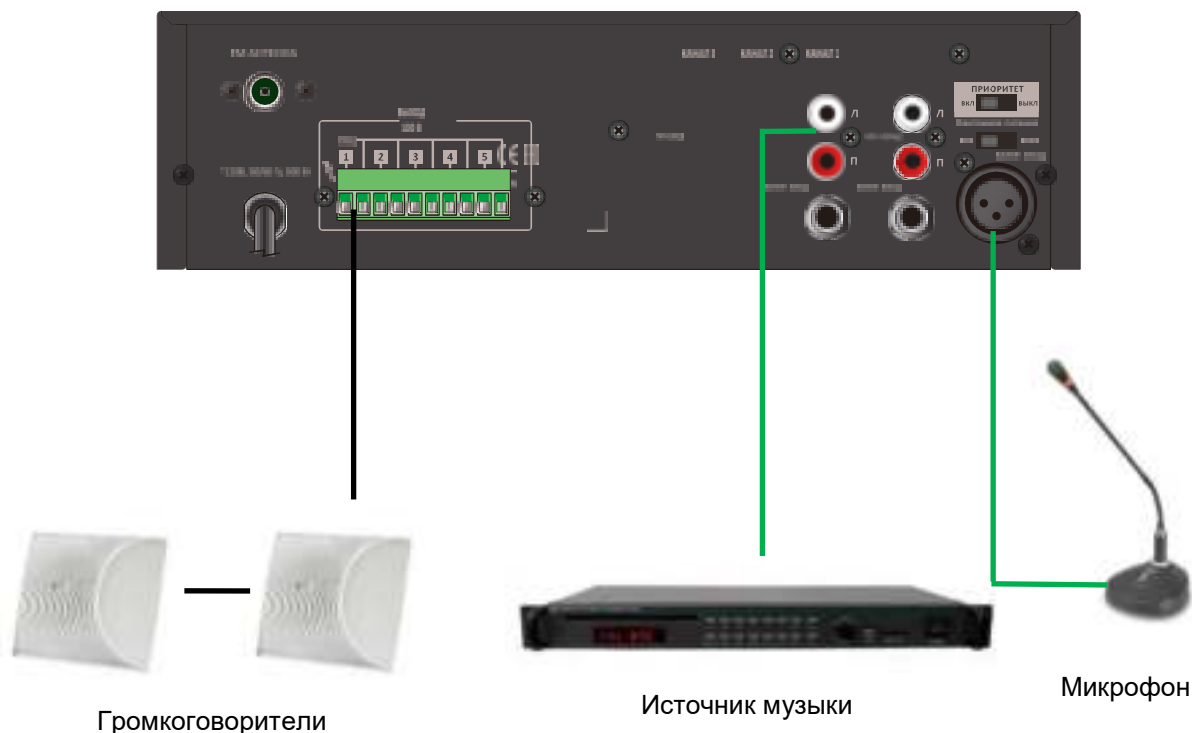
Рис. 2.1. Схема подключения LPA-TA-480MZ
