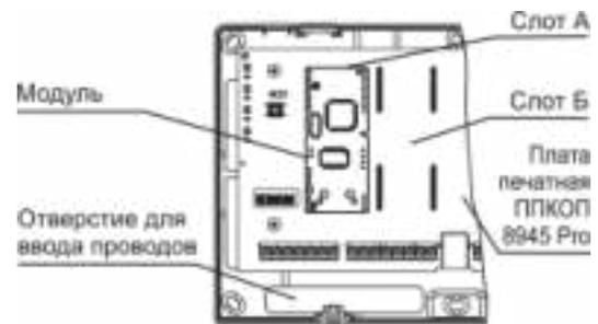
**4)** Провести провода сетевого интерфейса через отверстие для ввода проводов, обеспечить скрытую прокладку проводов. Электромонтаж к клеммам ППКОП 8945 Pro вести в соответствии с разделом 7 (таблица 2).
