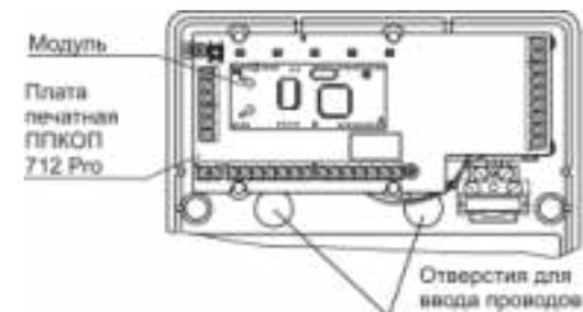
**4)** Провести провода сетевого интерфейса через отверстие для ввода проводов, обеспечить скрытую прокладку проводов. Электромонтаж к клеммам ППКОП 712 Pro вести в соответствии с разделом 7 (таблица 1).
