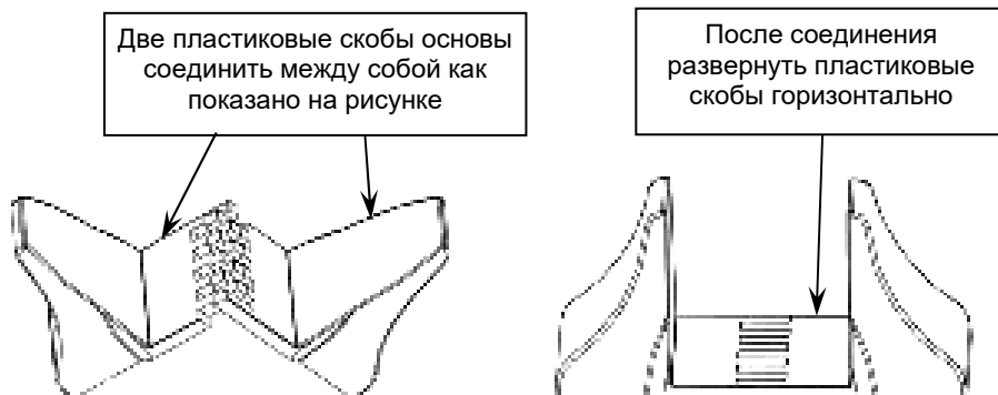
Рисунок 3 - Сборка пластиковых основ для вертикальной установки изделия.
