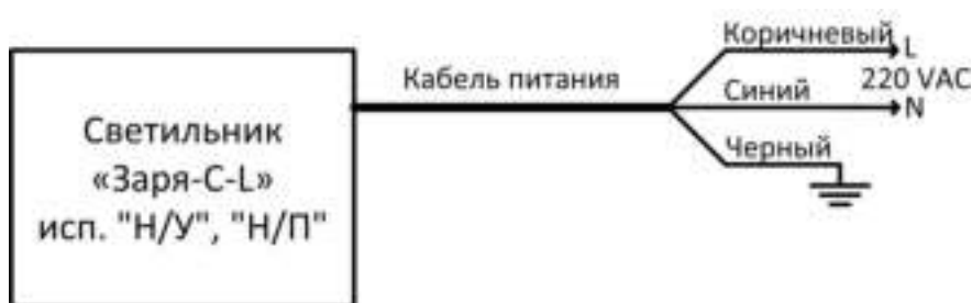
Рисунок 1.11. Схема подключения светильника «Заря-С-L» исп. «Н/У», «Н/П».
