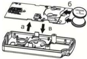
**5** Установить крышку с закрепленной на ней печатной платой в основание
