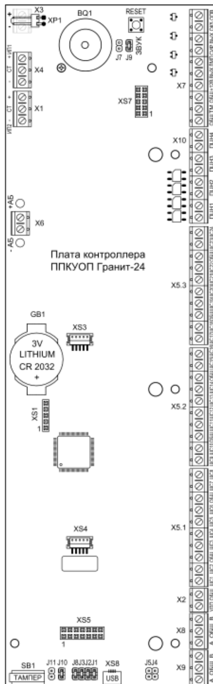
Рис.1 Плата контроллера прибора (вид со снятой панелью и платой индикации)
