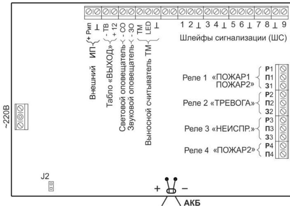
Рис.8. Вид на клеммы и разъемы для внешних подключений приборов «Гранит-3 Эк», «Гранит-6 Эк», «Гранит-9 Эк»
