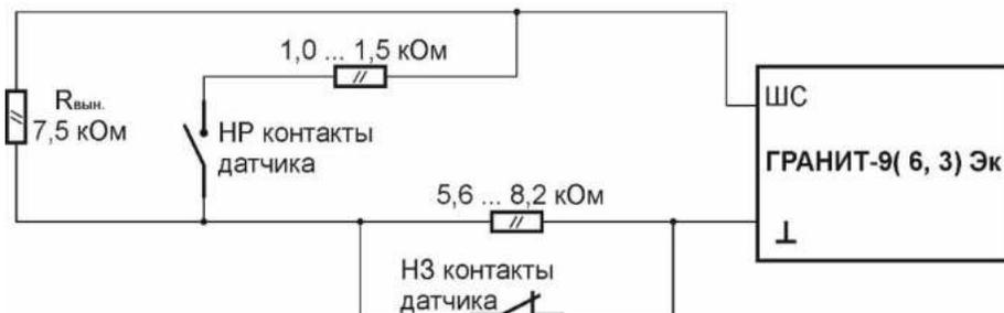
Рис.6. Схема включения технологических датчиков в ШСТ.
