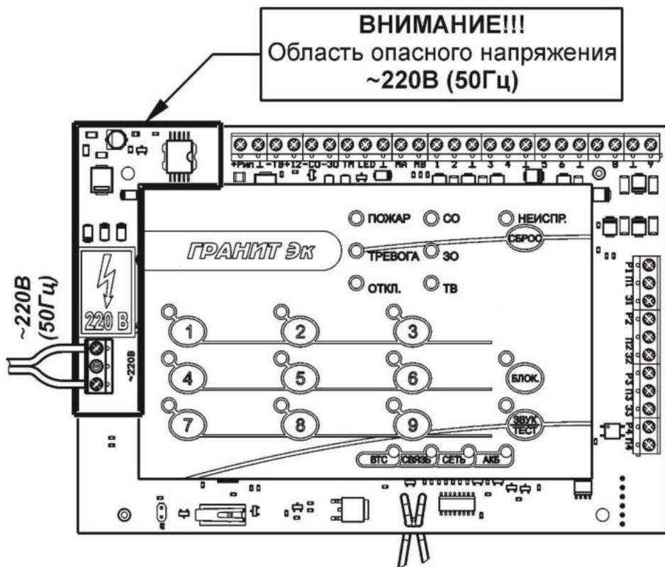
Рис. 10. Расположение на плате прибора области с опасным напряжением.
