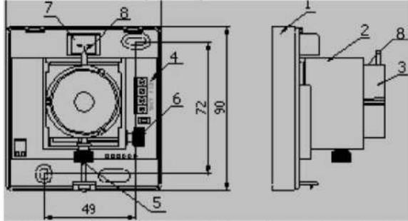
1-основание, 2-корпус, 3-оптический узел, 4-плата; 5-винт юстировки по вертикали, 6-винт юстировки по горизонтали, 7-зеркало, 8-визир.
