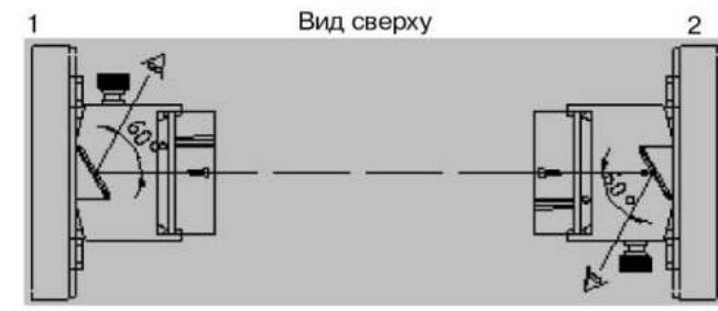
1 - Модуль излучателя, 2 - Модуль приемника
