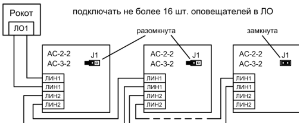
Рис.А5 Схема подключения оповещателей «АС-2-2», «АС-3-2» (параллельное соединение)
