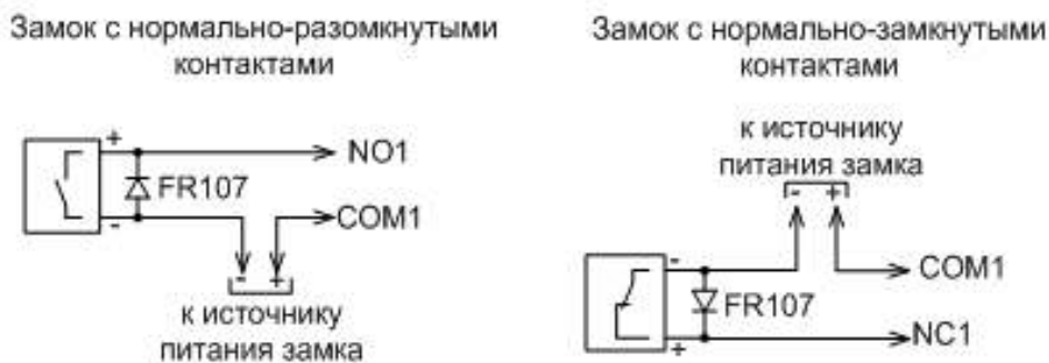
Рисунок 5. Рекомендуемые схемы подключения замков (разъём J10)
