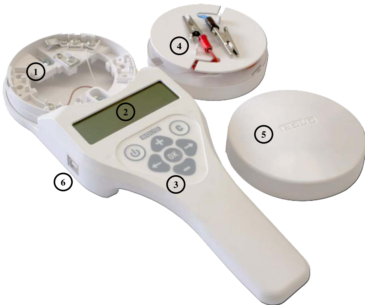
Рисунок 1. Внешний вид и органы управления программатора.
