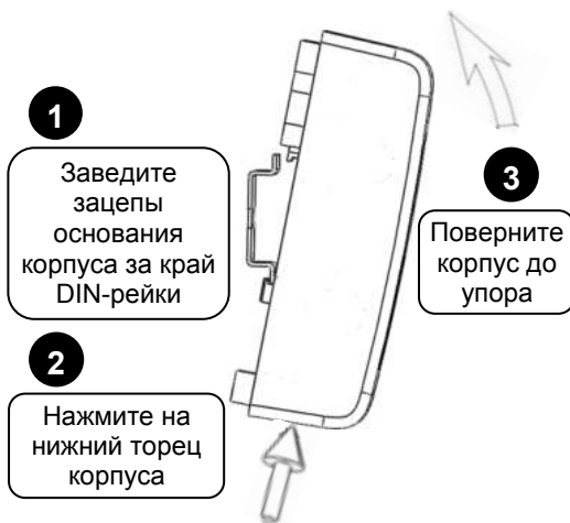
Рисунок 3. Крепление информатора на DIN-рейку
